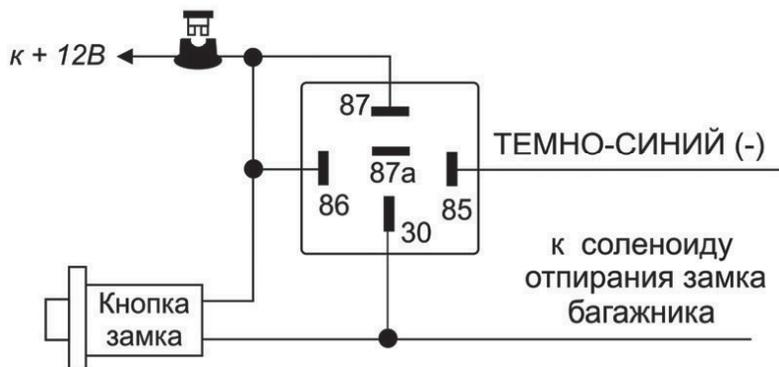
**Подсоединение:** Подсоедините ТЕМНО-СИНИЙ провод к контакту № 85 дополнительного 30А реле, подсоедините контакт № 86 реле к +12В. Подсоедините остальные контакты реле как показано на схеме.
