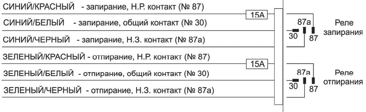
Перед подключением системы к установленным электроприводам замков дверей необходимо определить тип штатной системы центрального замка. Для этого – выньте выключатель дверного замка из панели водителя и протестируйте провода, идущие от выключателя.
