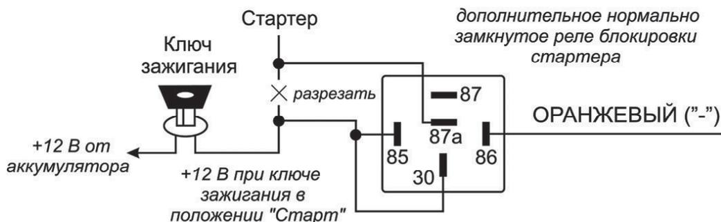
**Подсоединение:** Подсоедините ОРАНЖЕВЫЙ провод к контакту № 86 дополнительного реле блокировки стартера. Подсоедините контакт № 85 реле к проводу от замка зажигания, на который поступает напряжение +12В, когда ключ зажигания находится в положении “ЗАПУСК” (CRANK), и присутствует напряжение 0В, когда ключ зажигания находится в любом ином положении.
