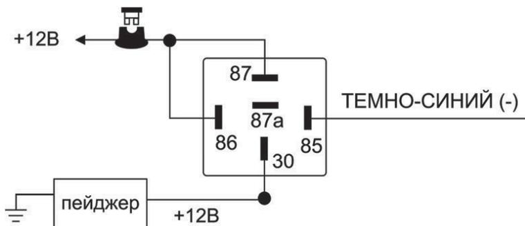
**Подсоединение:** Подсоедините ТЕМНО-СИНИЙ провод к проводу отрицательного триггера дополнительного пейджера. В том случае, если пейджер управляется положительным триггером, используйте дополнительное реле, как показано на схеме.
